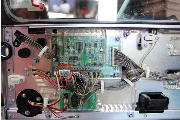
1. 最初に、ドアキーを左に回してガラス面を開けます。ガラス下の○18Pの白いコネクタを抜きます。
