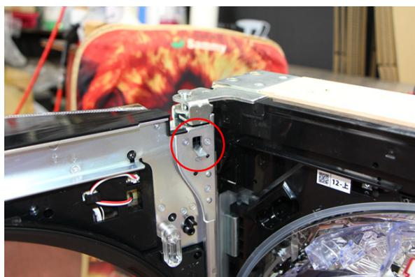
3. ○金属部分を上に押さえながら、ガラス枠全体を左にスライドさせるとガラス枠が外れます。
