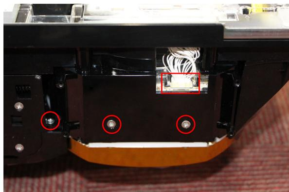
5. さらに○3ヶ所ネジを外してカバーをもう1枚外します。
