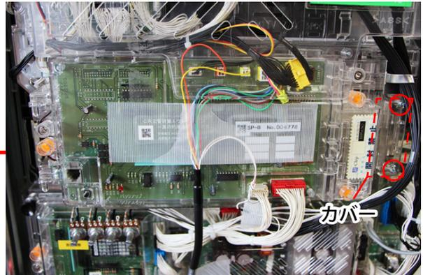
1. ○ネジを外し、カバーを外します。
